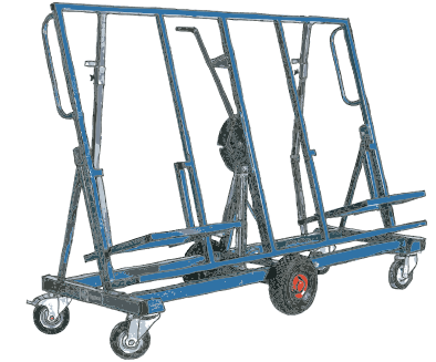
Gyprocin asennusvaunu on yhdistetty kuljetusvaunu ja työtaso, joka helpottaa kipsilevyjen kuljetusta ja käsittelyä. Vaunu sopii sekä 1200 mm:n että 900 mm:n kipsilevyille. Turvallinen ja tehokas käyttö mahdollistetaan säätämällä kääntötaso sopivalle leveydelle. 900 mm leveitä kipsilevyjä ei saa käsitellä asennusvaunussa silloin, kun sen kääntötaso on säädetty 1 200 mm leveille kipsilevyille.
